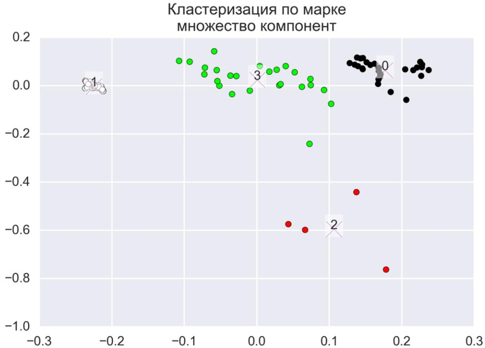
*(Пример понижения размерности и автоматической кластеризации переходного процесса. 0 – конечный продукт, 1 – исходный продукт, 2 – значимые выбросы, проблемы в технологии, 3 – процесс перехода.)*
